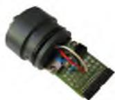
◀ Нижняя часть с платой подключений (Подключена плоским кабелем к основной плате)
